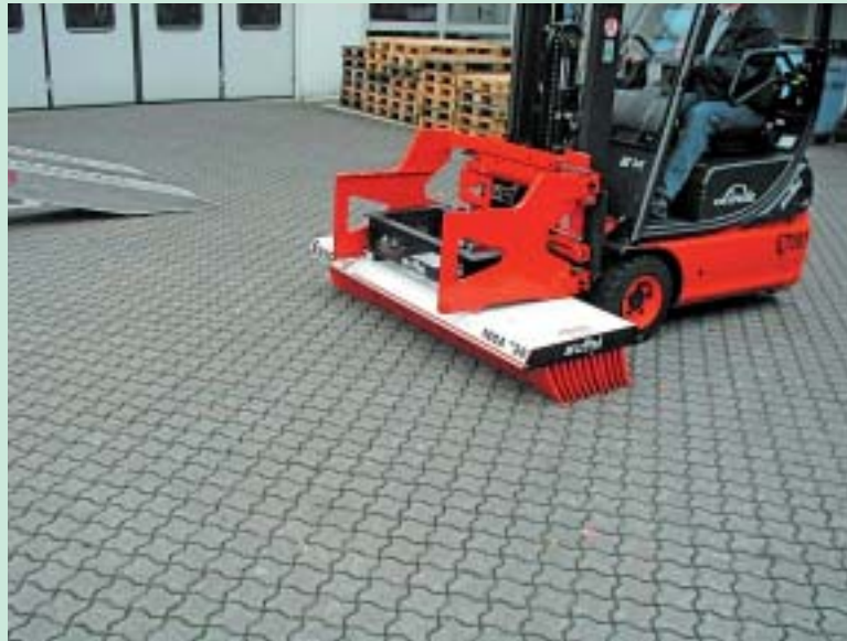
Mit Hilfe des neu entwickelten Adapters lässt sich das Kehrsystem „SweepEx“ auch mit einem Klammerstapler betreiben. Dies macht einen Staplerwechsel überflüssig. Bild: Suffel, Aschaffenburg
