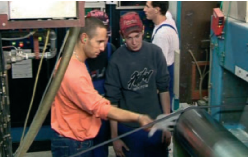
Zwei Darsteller bei der Arbeit: Die Gefährlichkeit einer Seilauflaufstelle wird mit Hilfe eines Handschuhs demonstriert.
