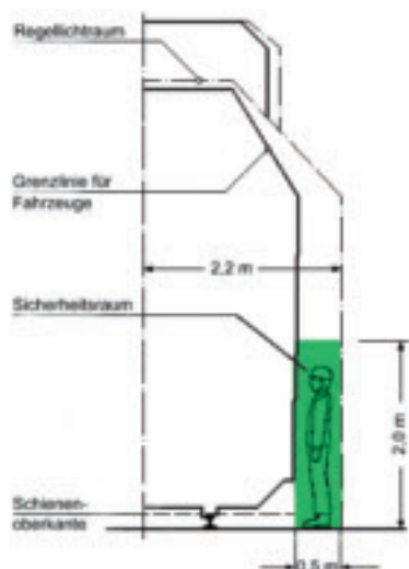
Bild 2: Sicherheitsraum bei Eisenbahnen nach EBO bzw. EBOA (siehe Text)
