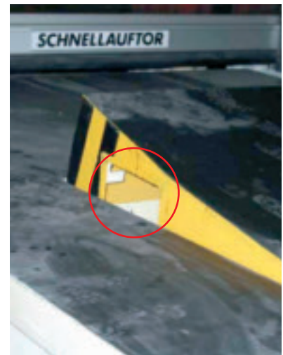
Die hinter dem Senkrechtförderer angebrachte Rollenwippe befördert die Papierrollen weiter in Richtung Rollenpackmaschine.
