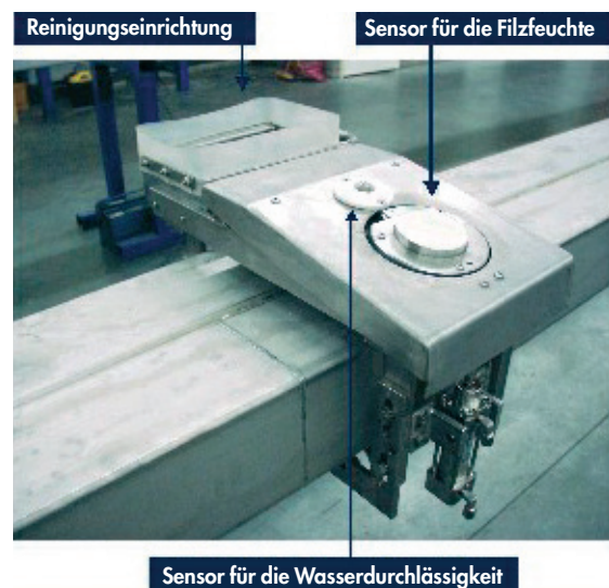
Vollautomatische, kontinuierliche Mehrfachmessung und Reinigung durch den kombinierten Mess- und Reinigungskopf
