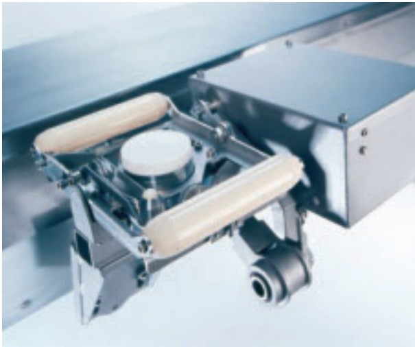
Beispiel eines Messaufnehmers für die Messung der Wasserdurchlässigkeit eines Filzes
