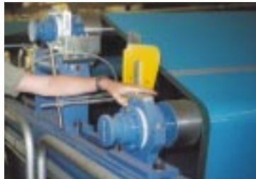
Bild 3: Auflaufstelle des Trockensiebtes an der Umlenkwalze in der Trockenpartie. Die vorhandene Verdeckung ist zu klein und kann leicht umgriffen werden.
