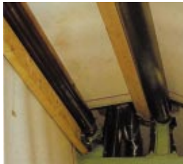
Bild 7: Zwei außenliegende Walzen, an denen die Auflaufstellen des Filzes maschinenbreit verdeckt sind.
