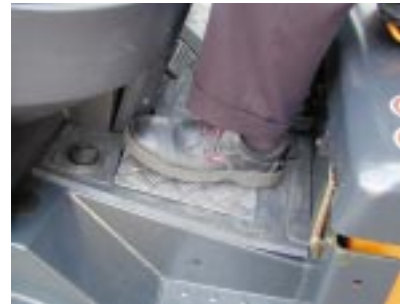
Der Fahrer betätigt den Fußschalter (optional)/ löst die Handbremse.
