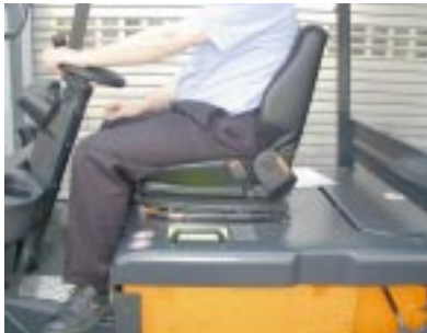
Der Fahrer nimmt auf dem Fahrersitz Platz, die Sitzbelegung wird erkannt.
