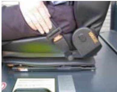
Der Fahrer schließt den Gurt, wodurch ein Schalter im Gurtschloss betätigt wird.
