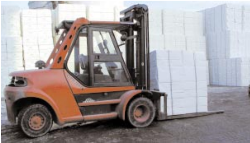
Bietet Schutz: Die geschlossene Fahrerkabine, idealerweise mit Klimaanlage ausgerüstet.
