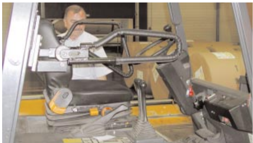
Nach oben wegschwenkende Türbügel, mit der Feststellbremse verriegelt.
