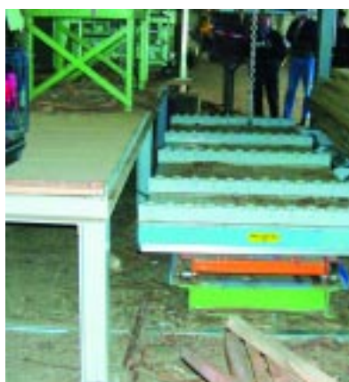
Rechts im Bild der zur tödlichen Falle gewordene Hubtisch, links davon das Arbeitspodest.
