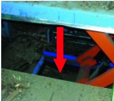
Die Quetschstelle zwischen Unterkante Hubtisch und dem Arbeitspodest wurde dem Auszubildenden zum Verhängnis.
