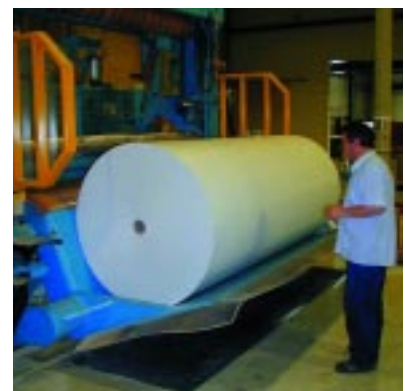
Eine Schaltmatte unter der Absenkbühne, in Verbindung mit Abweisern an der Bühne, sichert gegen Quetschen beim Absenken.
