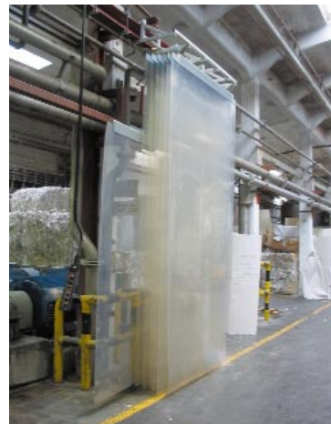
Leichte Zugänglichkeit im Wartungs- und Reparaturfall: Die an Schienen geführten Vorhänge sind kein Hindernis.
