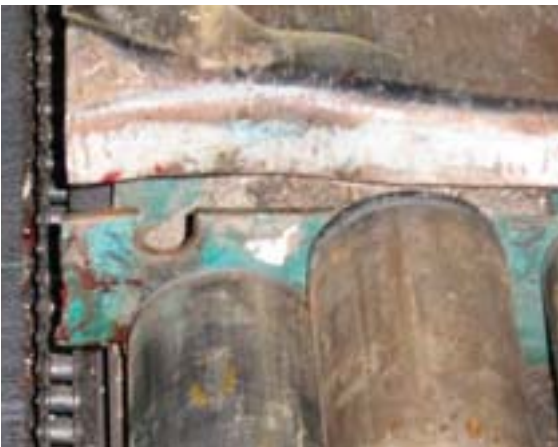
Kleine Ursache..... Deutlich zu sehen, die deformierte Lagerstelle
