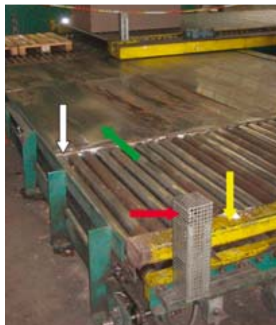
Die Lichtschranke (roter Pfeil) löste den Pusher (gelber Pfeil) aus, der die Paletten in Richtung Packanlage (grüner Pfeil) schiebt. Die Quetschstelle (weißer Pfeil) befindet sich zwischen Pusher und Rollenbahn.
