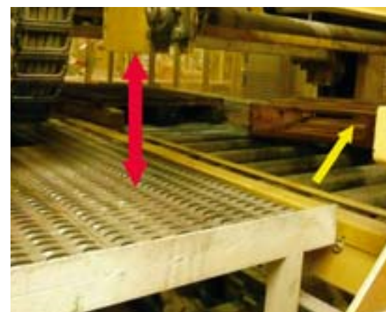
An dieser Stelle (roter Pfeil) wurde der Verletzte eingequetscht. Im Hintergrund (gelber Pfeil) die verrutschte Palette.
