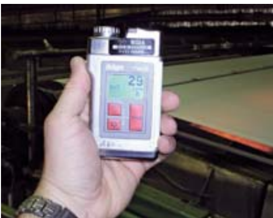
Bild: Gefahrstoffmessung an einer Papiermaschine. Die spezielle Oberflächenbeschichtung des Papiers führt hier zu einer Überschreitung des zulässigen Grenzwertes für Ammoniak (20 ppm).
