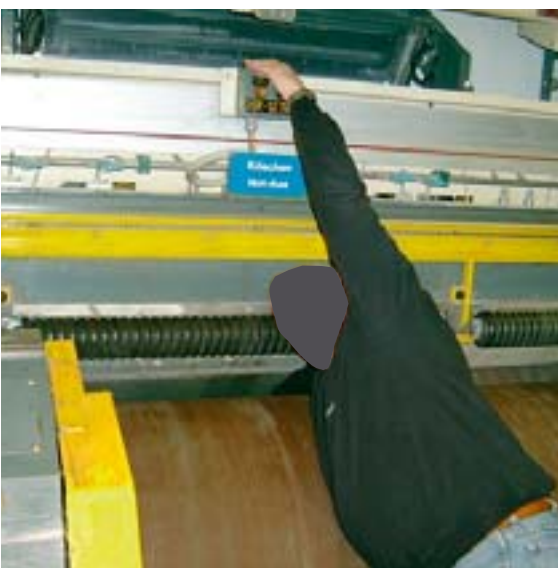
Position des Verletzten nach dem Herabfahren der Bahnhalteleiste. Oben im Handbereich ist die Vor-Ort-Bedienung der Bahnhalteleiste und eine Not-Halt-Reißleine angebracht.
