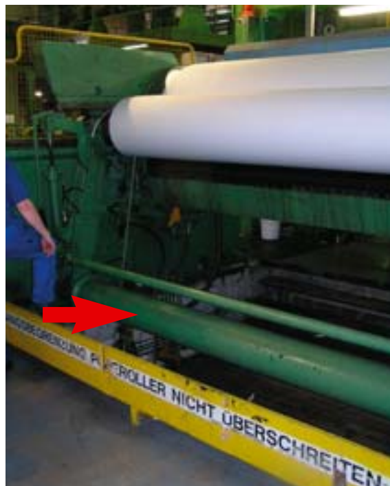
Auf der Achse des Sekundärarmes (Pfeil) stehend geriet der Maschinenführer mit seinem Arm in die Einzugsstelle zwischen Tambour und Stützwalze
