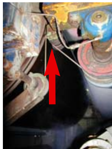
Beim Überführen der Bahn in die Trockenpartie geriet der Werkführer mit seiner rechten Hand zwischen Seilrolle (Pfeil) und Trockenzylinder.
