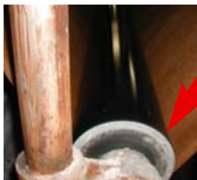
In diese ungesicherte Auflaufstelle geriet der Verletzte mit einem Zipfel seiner offenstehenden Weste.
