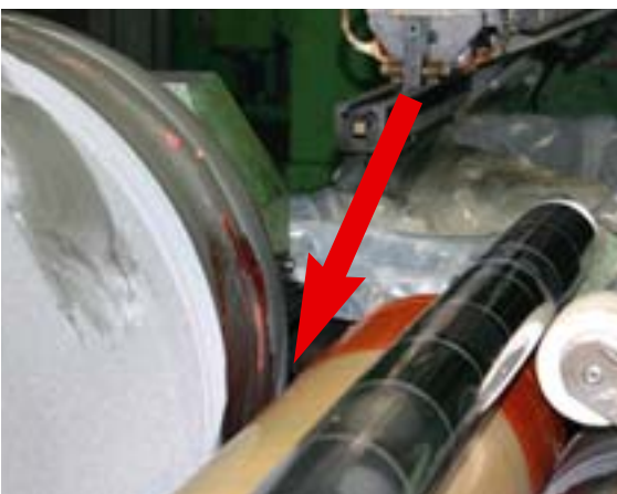
In diese Einzugstelle (Pfeil) geriet der Maschinenführer bei seinem Reinigungsversuch
