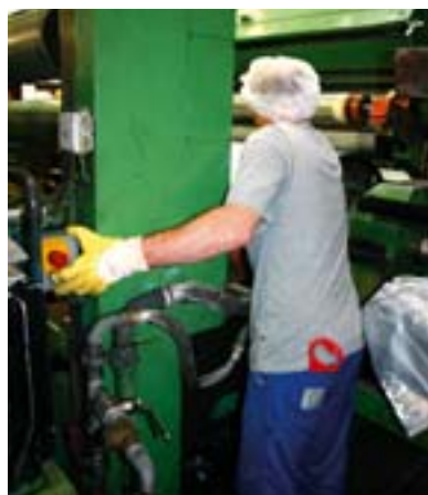
Im Bild zu sehen: Die vorgeschriebene Arbeitsweise, Reinigung im Tipbetrieb
