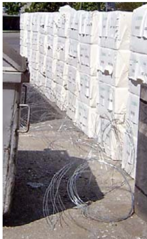
Bereits entdrahtete Zellstoff-Units. Im Vordergrund die teilweise aufgerollten Drähte.
