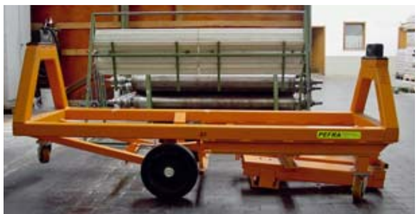
Platzsparend und automatisch gebremst: der abgekuppelte Tambourtransportanhänger
