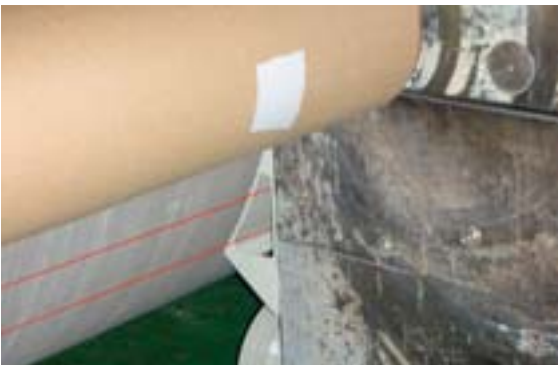
Bild 2: Formstück mit Aussparung für zwei Lichtstrahlen (rot) zur Sicherung der Einzugsstelle zwischen Stützwalze und Wickelhülse
