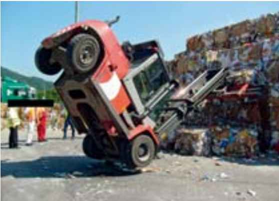
Bild 1: Der vornüber gekippte Stapler
