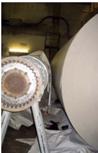
Die Quetschstelle befand sich zwischen dem Leertambour (links) und dem im Kran hängenden Volltambour.
