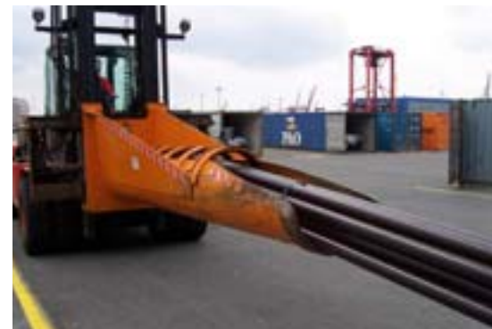
Preiswürdig: Anbaugerät für Gabelstapler, um Rohre in Container zu verladen (Foto: Eurogate Container Terminal Bremerhaven GmbH)
