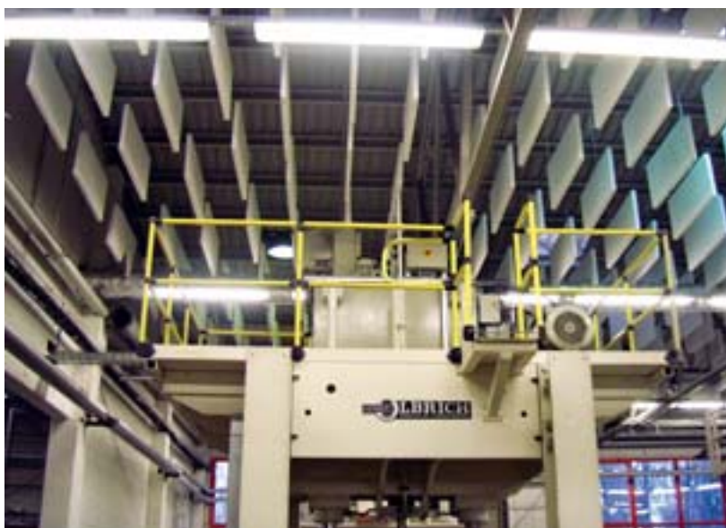
Bild 1: Verformstanze mit Kulissenabsorbern
