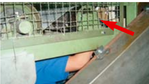
Schwierig, aber dennoch erreichbar: Die Auflaufstelle (Pfeil) am Bandförderer
