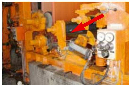
Kein sicherer Standplatz: Die Stuhlung der Pappmaschine im Bereich der Pressenpartie. Pfeil: die Auflaufstelle
