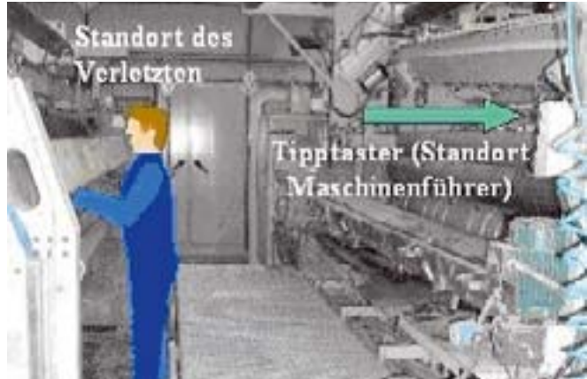
Situation beim Aufführen der Bahn (Rewinder)
