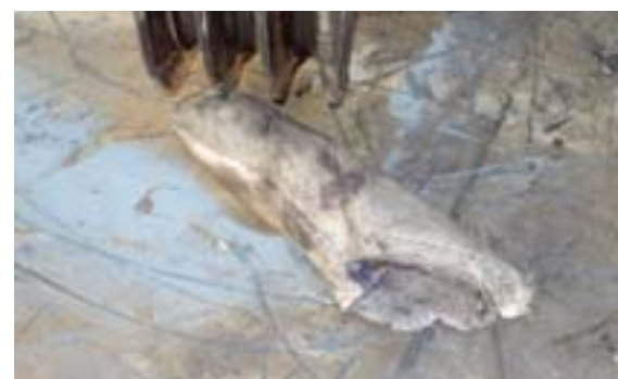
Ausgerissener Finger des Lederhandschuhs mit Spuren der Riemenscheibe.
