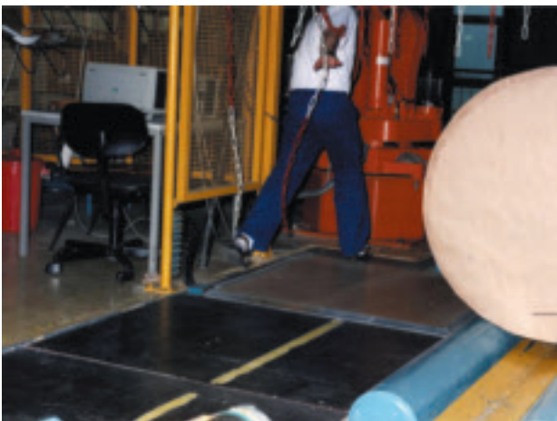
Hier hat der Hersteller die Schutzeinrichtung Schallmatte nicht ausreichend dimensioniert. Das Verhalten des Mitarbeiters – Zugang in den geschützten Bereich unter Umgehung der Schutzeinrichtung – war vorhersehbar.
