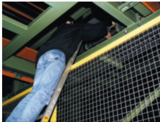
Im Gegensatz zu der leichten Überwindbarkeit der Schallmatte, stellt das Übersteigen eines Zaunes mit Hilfe einer Leiter im Allgemeinen kein vom Hersteller zu berücksichtigendes vorhersehbares Fehlverhalten dar. Es sei denn, er hat an dieser Stelle ein Bedienelement angebracht.
