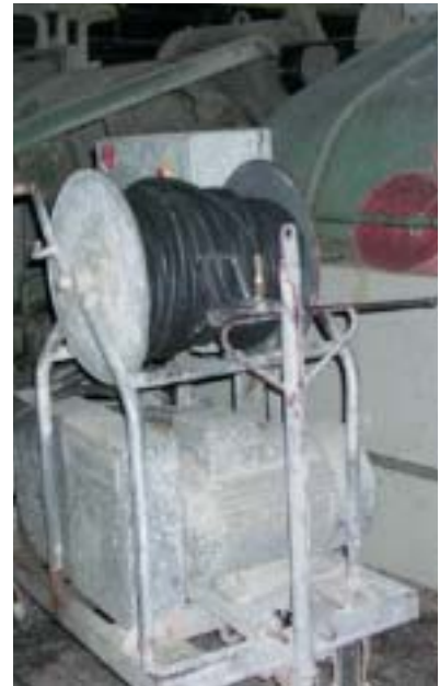
Flüssigkeitstrahler mit einem max. Betriebsdruck von 100 bar und einer Fördermenge von 92 l/min.
