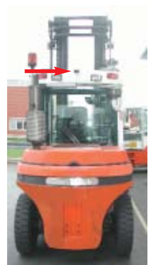
Der 7,5 t-Stapler wurde mit zwei Kameras ausgerüstet (Pfeile)
