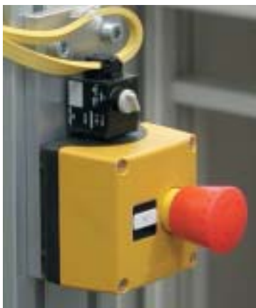
Bild 2: Unverwechselbar NOT-AUS: rotes Stellteil vor gelbem Hintergrund
