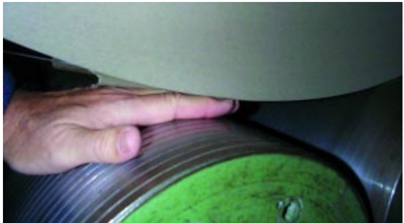
Hand zwischen Rolle (hier angehoben und gesichert) und Tragwalze ... für jeden Mitarbeiter an einer Rollenschneidemaschine eine schreckliche Vorstellung.
