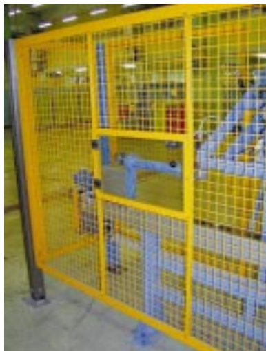
Bild 1 Durch die Öffnung in der Umzäunung lassen sich notwendige Einstellarbeiten durchführen. Gefahrstellen liegen soweit weg, dass sie durch diese Öffnung nicht erreichbar sind.
